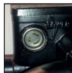
Obraz 15: Okienko kontroli płynu hamulcowego
