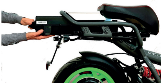
Obraz 10: Wymowanie baterii
